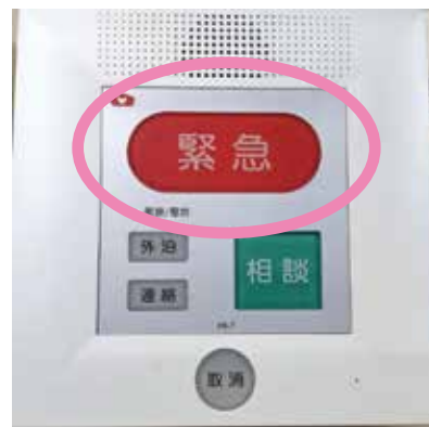
緊急通報装置の本体
