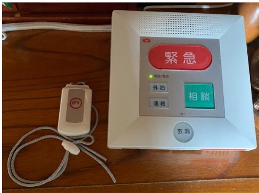
（緊急通報装置とペンダント）
