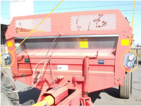
チェーン等の丈夫な装置でつなぐ 前部反射器及び車幅灯の設置例
