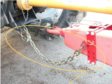
チェーン等の丈夫な装置でつなぐ 前部反射器及び車幅灯の設置例
