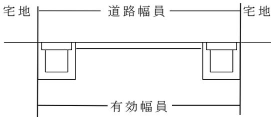
U型側溝（蓋なし）築造の場合
