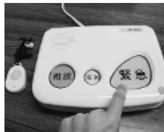
緊急通報装置
