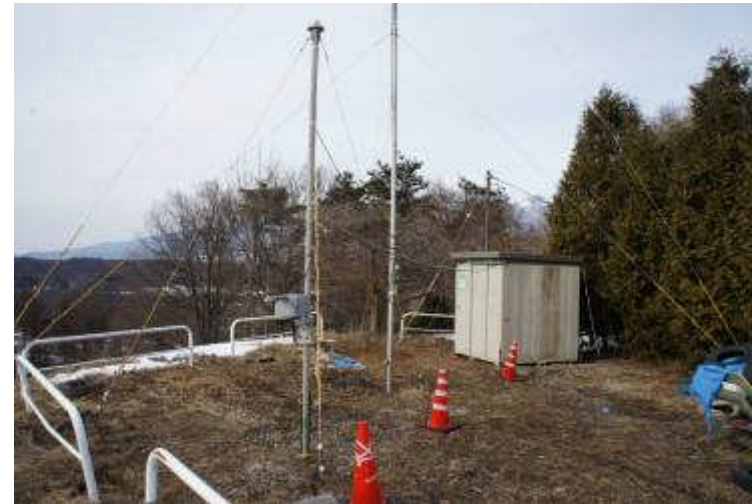
▲建設候補地に設置された風向風速計、放射収支計
